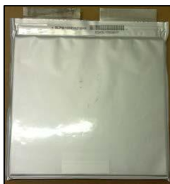
Celda de Li de 40 Ah al final de su vida útil
