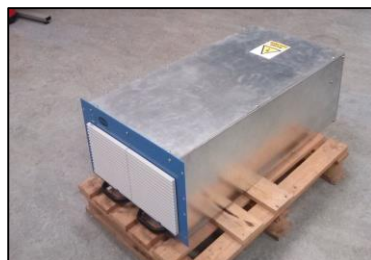
Batería de alta potencia formada por 36 celdas
